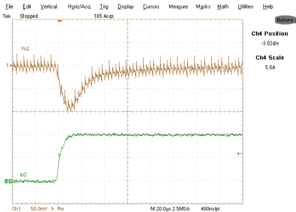
Fig.25: Load Transient 0-10A. Ch 1 : V o2 (1V8), Ch 4 : I o2
